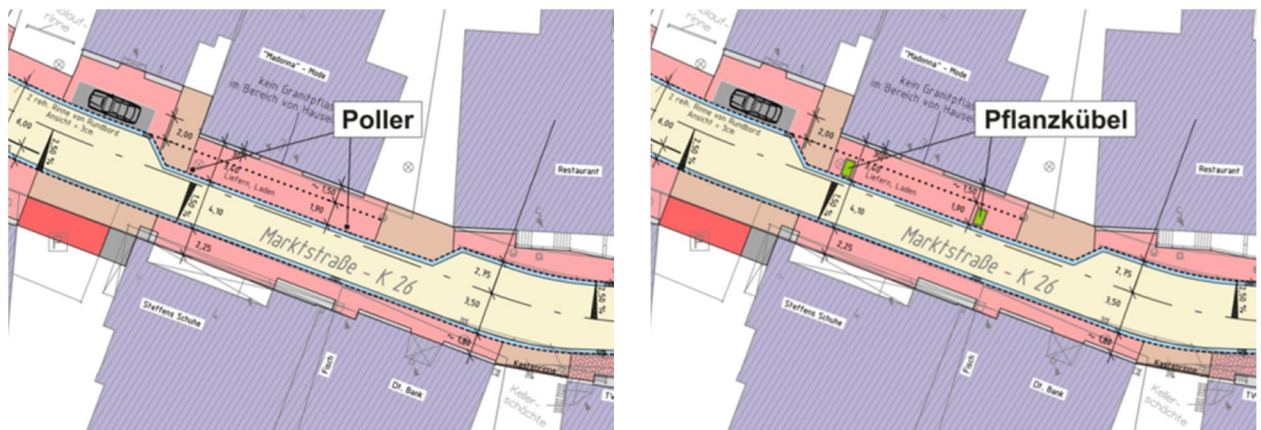
Abb. 13 Umsetzung der Einengung mit Pollern (links) oder Pflanzkübeln (rechts)
