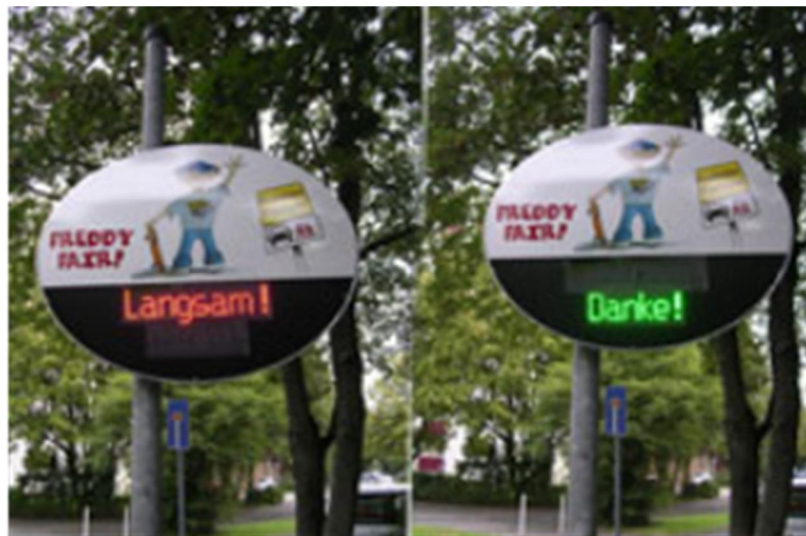
Abb. 17 Geschwindigkeitsanzeige, Anzeige bei Einhaltung der zul. Höchstgeschwindigkeit (links) und beim Überschreiten der Höchstgeschwindigkeit (rechts)
